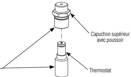
**B** Insérer une tige de 7/16" de diamètre dans la valve jusqu'à ce qu'elle touche le haut du poussoir attaché au piston. Marquer la longueur de la tige à l'intérieur du robinet. Pousser la tige jusqu'à ce que le piston arrête et marquer la nouvelle longueur.
