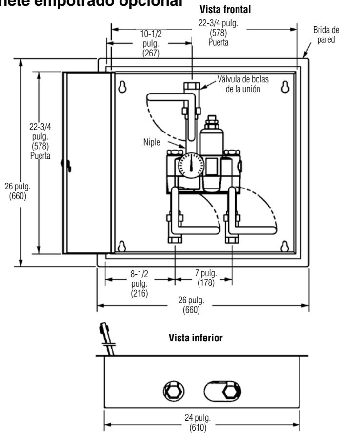
**Orificio de la pared: 62 cm (24-1/2 pulg.) de ancho x 62 cm (24-1/2 pulg.) de alto**
