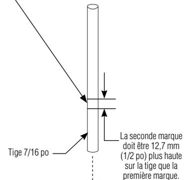
**D** Pousser le mécanisme en haut et en bas plusieurs fois pour s'assurer que le piston se déplace librement et de façon constante. Si non constant, répéter la Procédure C jusqu'à satisfaction, ou remplacer. Contacter votre représentant Bradley et lui demander un Kit de Piston/ Revêtement (référence S65-409).
