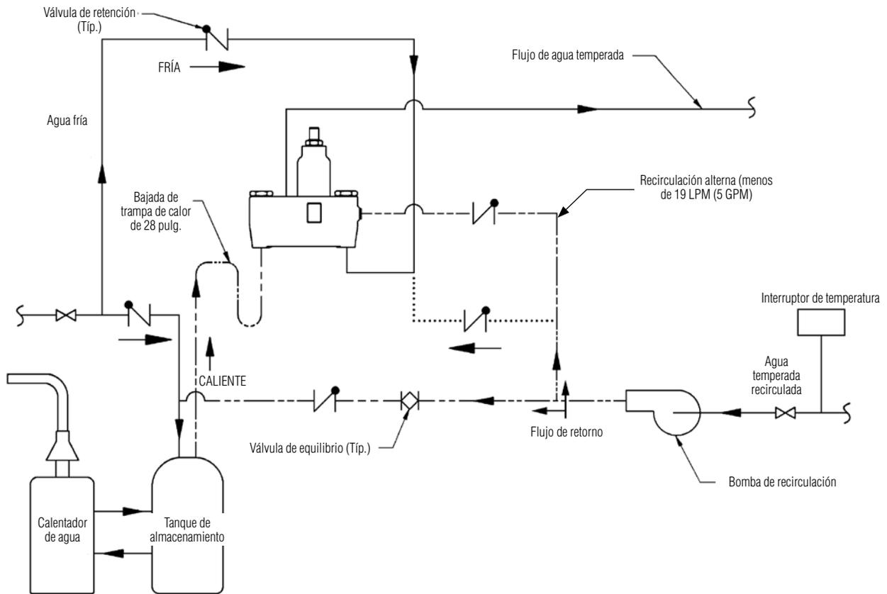
1. Apague la bomba de recirculación y abra el suministro de agua en los accesorios de emergencia [se requiere un caudal de agua de 38 a 57 LPM (10 a 15 GPM)].
