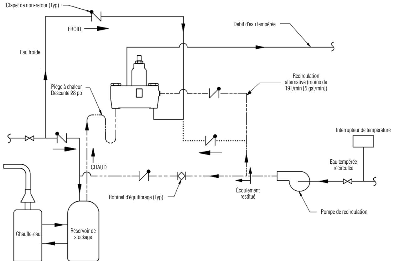
1. Fermer la pompe de recirculation et ouvrir l'alimentation en eau au niveau de l'appareil d'urgence (un débit d'eau de 38-57 l/min [10-15 gal/min] est requis).
